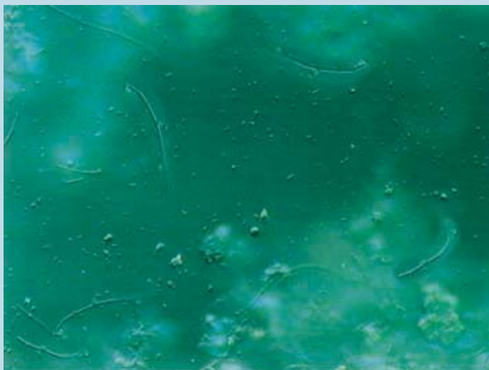
Słabo rozwinięta struktura osadu czynnego jako następstwo braku tlenu
