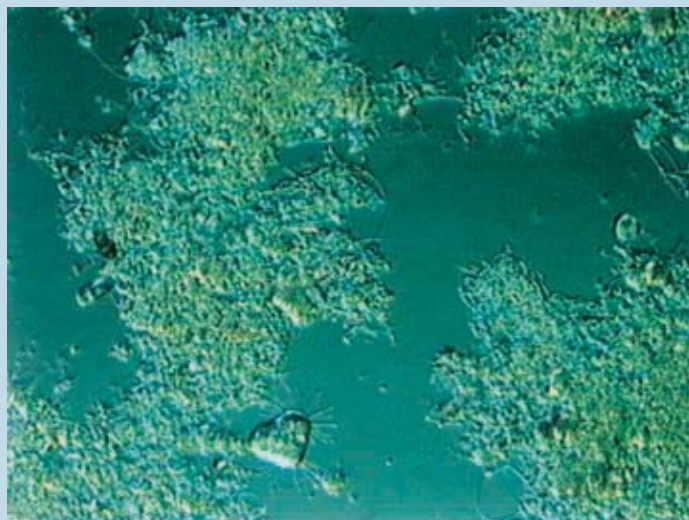
Dobrze rozwinięta struktura osadu czynnego po 14 dniach natleniania
